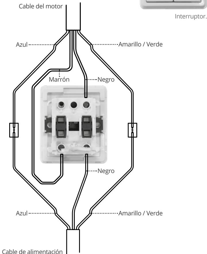
Una vez realizadas las conexiones del motor con el interruptor, se debe colocar el embellecedor del interruptor y fijar el mismo en un lugar fijo y protegido. Las uniones de las conexiones deben estar correctamente instaladas y seguras para un correcto uso del motor del toldo.
