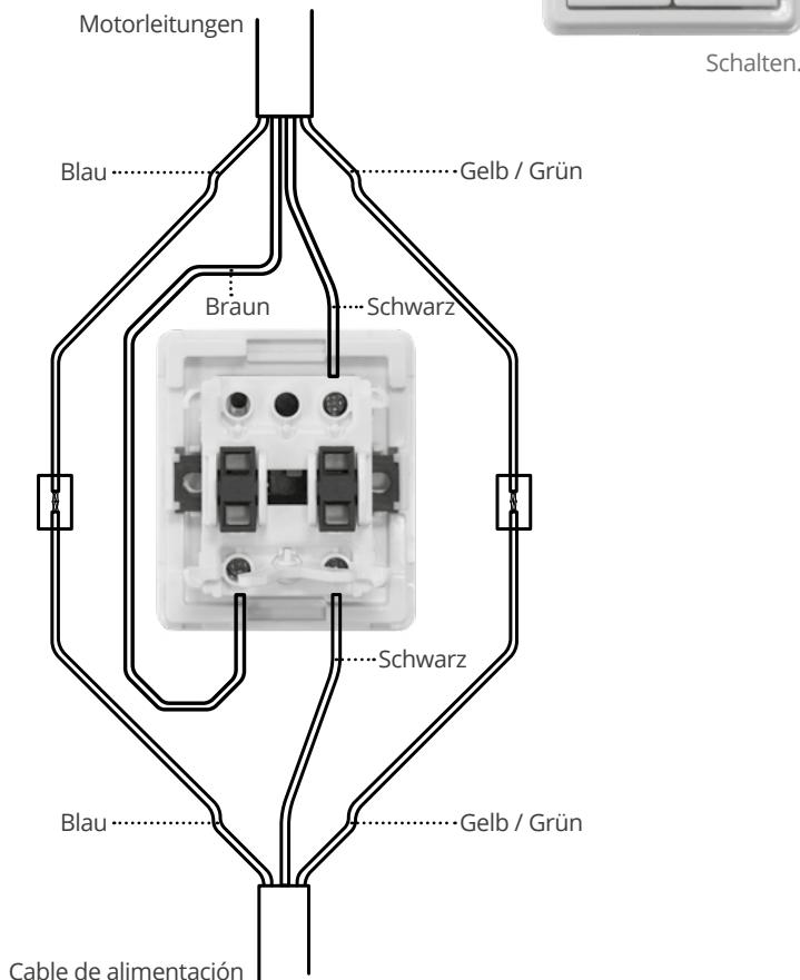
Nachdem die Motoranschlüsse mit dem Schalter verbunden wurden, muss die Schalterabdeckung angebracht und der Schalter an einem festen und geschützten Ort befestigt werden. Die Verbindungen müssen für den korrekten Einsatz des Markisenmotors, korrekt installiert und sicher sein.
