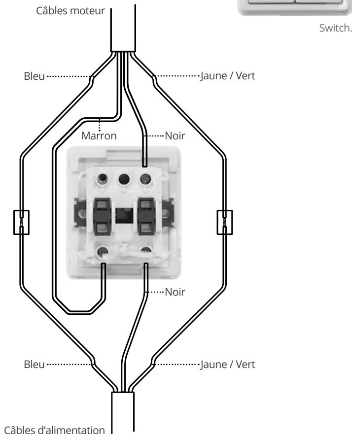
Une fois les connexions du moteur avec l'interrupteur effectuées, le couvercle de l'interrupteur doit être placé et l'interrupteur fixé dans un endroit fixe et protégé. Les connexions des connexions doivent être correctement installées et sécurisées pour une utilisation correcte du moteur de store.
