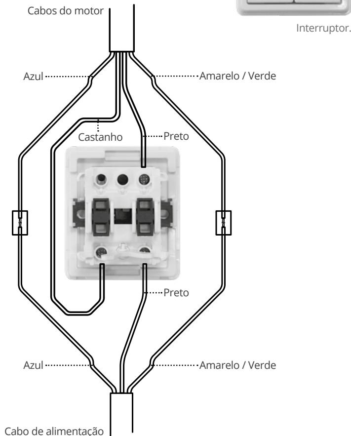
Uma vez feitas as conexões do motor com a chave, a tampa da chave deve ser colocada e a chave fixada em um local fixo e protegido. As conexões das conexões devem ser instaladas corretamente e seguras para um uso correto do motor do toldo.
