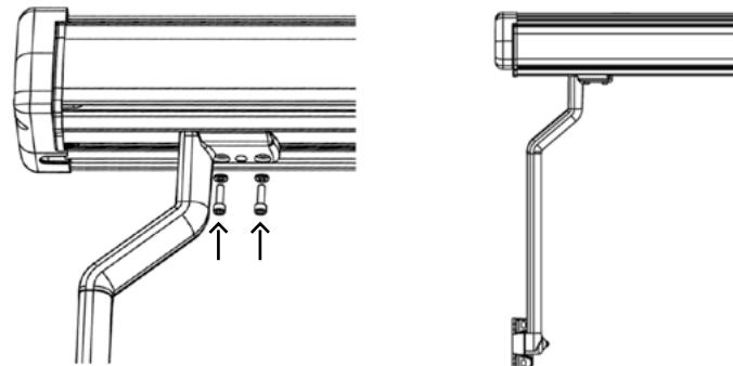
5. Finalmente, apresentar os braços na parede, marcar os furos e fazer furos para os fixar com parafusos.
