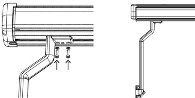
5. Schließlich werden die Arme an der Wand präsentiert, die Löcher angezeichnet und Löcher gebohrt, um sie mit Schrauben zu befestigen.
